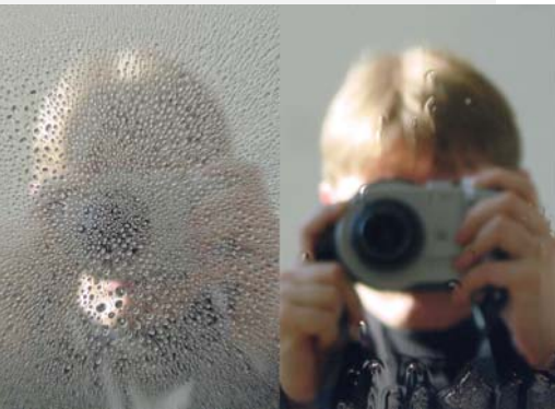
Bild 1: Photokatalytisch aktive Spiegelbeschichtung, links: nicht aktiviert (Tropfenbildung), rechts: aktiviert (Super-Hydrophilie)
