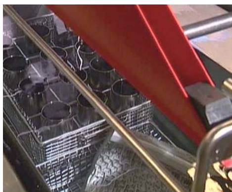
Bild 2: Endreinigung im Spülbad, wahlweise mit Ultraschall oder mit Stickstoffspülung
