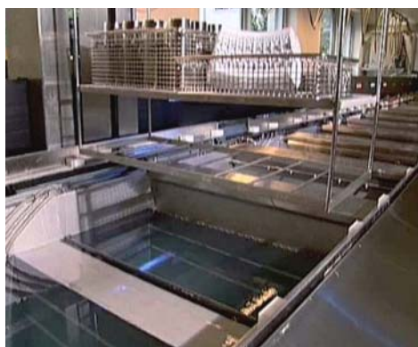
Bild 3: 15-stufige Reinigungslinie mit Trocknung für Bauteile bis 80 kg
