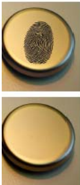
Antifingerprint-Beschichtung oben ohne Beschichtung, unten mit Beschichtung
