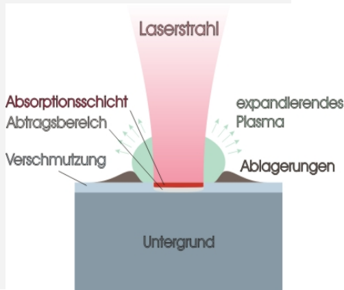
Bild 1: Prinzip des Laserstrahlreinsigens
